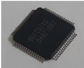
ภาพที่ 1 แสดงลักษณะแพ็คเกจของ 64L TQFP (Thin Quad Flat Package) ขนาด 10X10 mm
